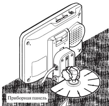
Согните крепежное основание в соответствии с кривизной приборной панели.
