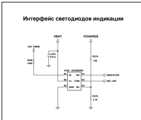
Схема цепи основной платы
